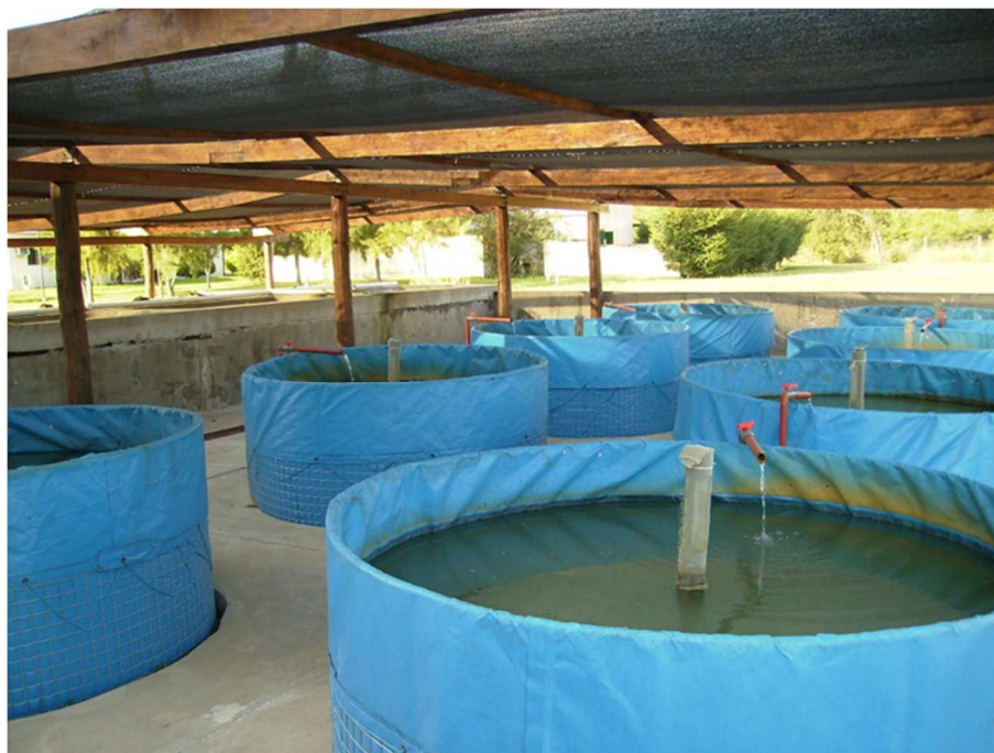
Foto 7: Estanques de lona con estructura metálica en el CENADAC. En este caso en lugar de geomembrana se utilizó lona del tipo que se utiliza para las piletas de natación. Fuente: G. Dapello – DNA.
