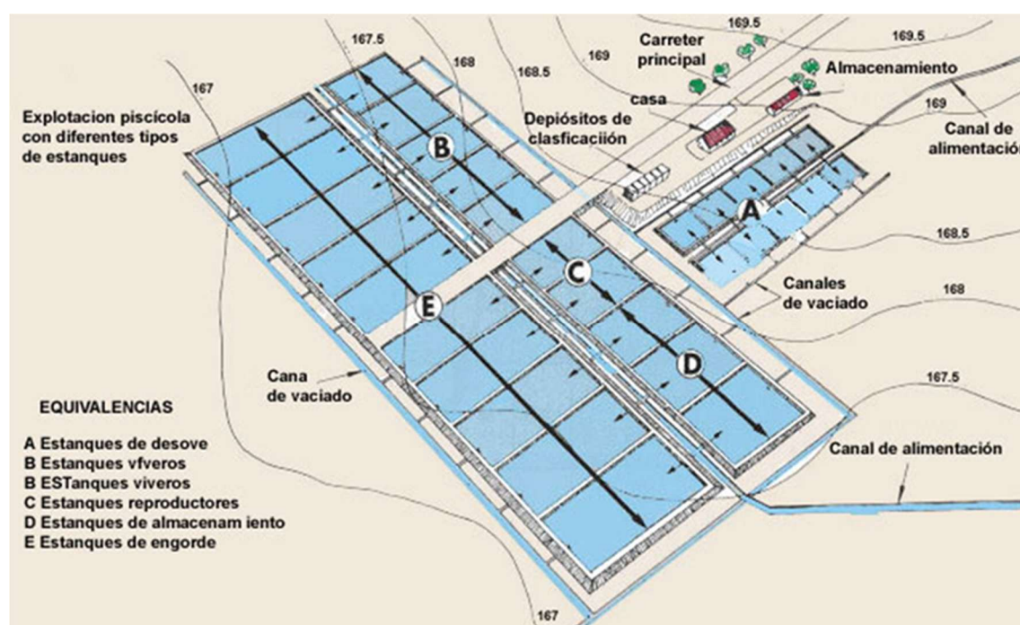
Esquema 1: Diseño de una explotación acuícola con diferentes tipos de estanques según FAO.
